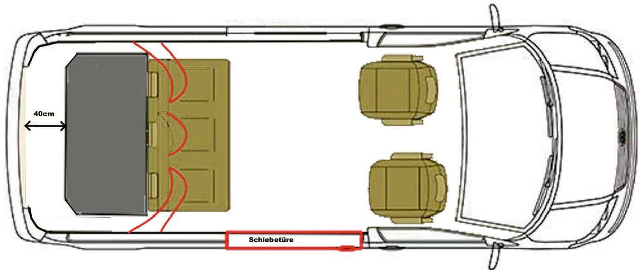
Die Einbauposition der Schlafsitzbank EVO3 in der vorderen Position = Sitzfläche der Sitzbank bündig abschließend mit der Schiebetürenöffnung und ca. 40cm Freiraum von der Heckablage zur Heckklappe bzw. Flügeltüre.
