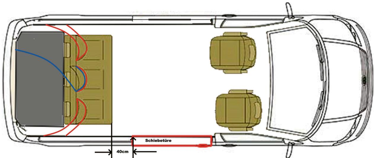
Die Einbauposition der Schlafsitzbank EVO3 in der hinteren Position = Heckablage der Sitzbank bündig mit der Heckklappe bzw. den Flügeltüren und ca. 40cm Freiraum von der Sitzfläche zur Schiebetüre.
