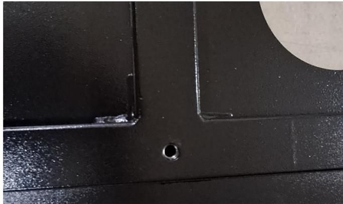
Die Locher müssen in den Erhöhungsadapter selbst gebohrt werden.
