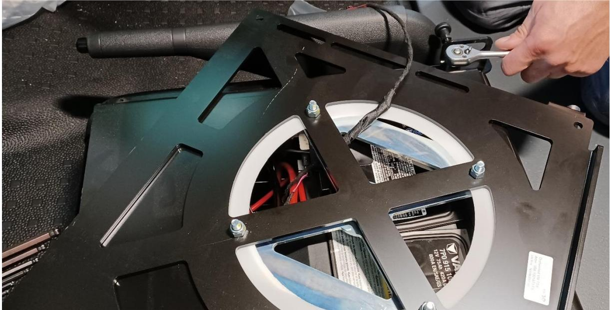
Dann die Drehkonsole festschrauben und den Sitz an die Drehkonsole schrauben
