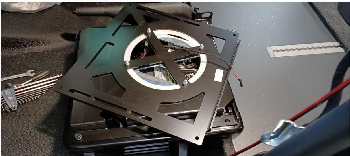
Drehkonsole auf die Konsole legen der Hebel muss immer zur Handbremse zeigen.
