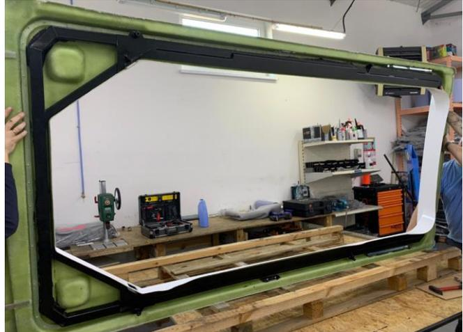
Verschraubungspunkt des Verstärkungsrahmen mit der Fahrzeugstruktur
